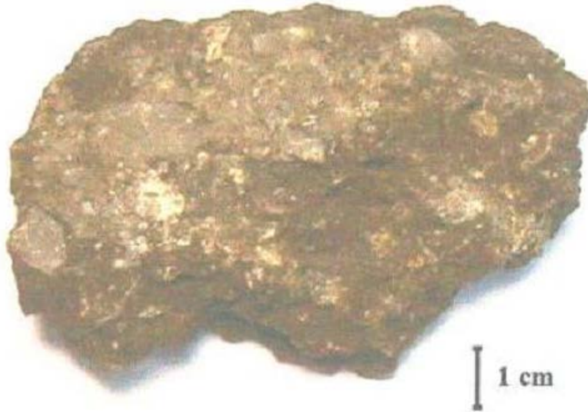
Grumo resultante da fresagem na espessura de 5 cm
